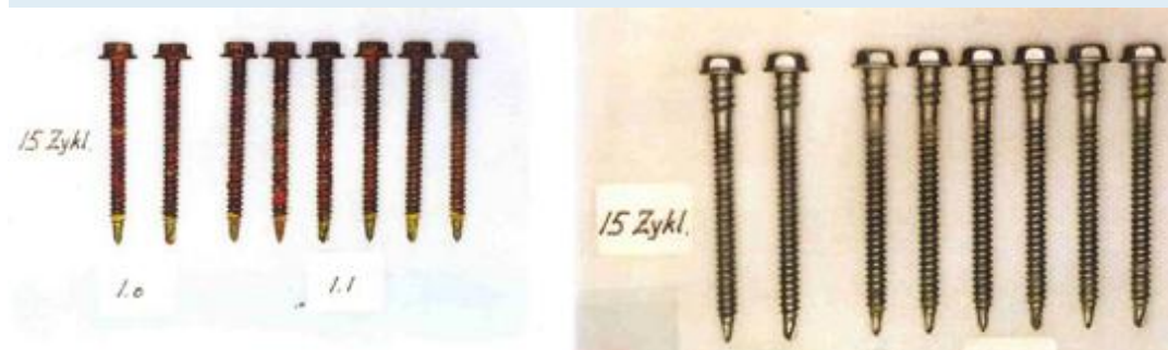
Foto 5 a 6 : Koroze střešních šroubů po absolvování 15 Kesternichových cyklů – vlevo nekvalitní, korozi zcela napadený výrobek, vpravo šrouby s kvalitní antikorozní ochranou bez známky zasažení korozi ( výrobce SFS intec )
